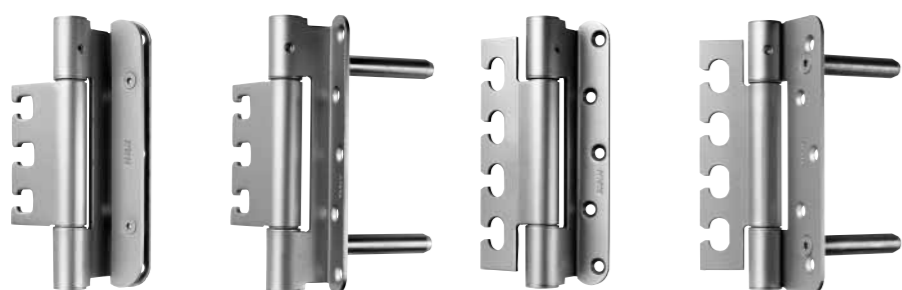
Objektband 2049/160/56 FD für überfälzte Türen mit durchlaufender Dichtung Länge 160 mm Anschlussmaß 56 mm Objektband 2039/160/56 SI mit Sicherheitsstiften für überfälzte Türen Länge 160 mm Anschlussmaß 56 mm Objektband 2081/160/96 für überfälzte Türen Länge 160 mm Anschlussmaß 96 mm Objektband 2086/160/96 TZ mit Tragzapfen für stumpf einschlagende Türen, Länge 160 mm Anschlussmaß 96 mm
