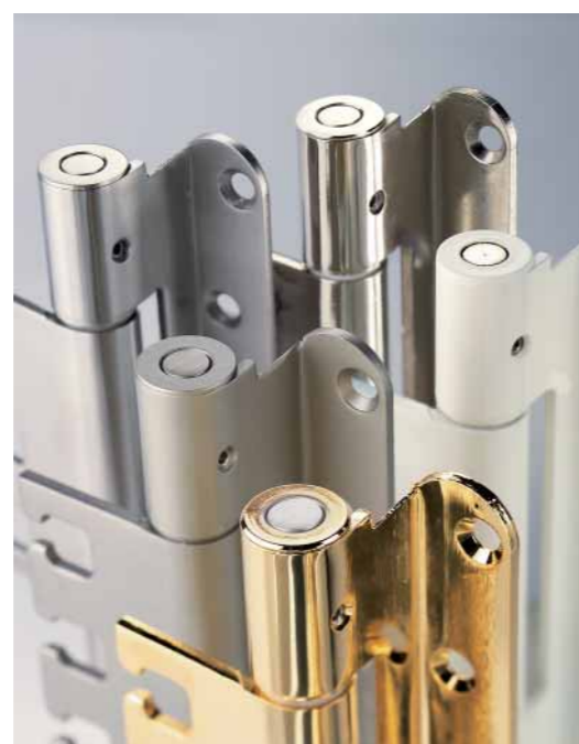
Objektband 2049/160/56 FD für überfälzte Türen mit durchlaufender Dichtung Länge 160 mm Anschlussmaß 56 mm Objektband 2039/160/56 SI mit Sicherheitsstiften für überfälzte Türen Länge 160 mm Anschlussmaß 56 mm Objektband 2081/160/96 für überfälzte Türen Länge 160 mm Anschlussmaß 96 mm Objektband 2086/160/96 TZ mit Tragzapfen für stumpf einschlagende Türen, Länge 160 mm Anschlussmaß 96 mm
